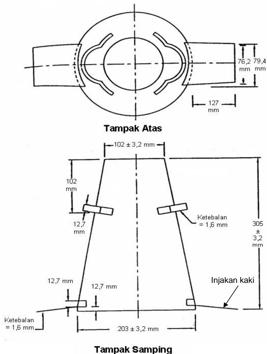
**Gambar 1 Cetakan untuk uji slump (kerucut Abram)**
